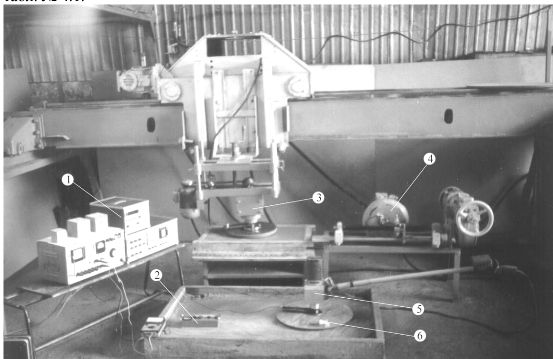
Рис. 1. Экспериментальный стенд вибрационной дисковой заглаживающей машины 1 – приборы для измерения виброперемещения и частоты колебаний; 2-прибор ИШБ – 8А; 3 – ВДРО с крутильными колебаниями; 5 – ВДРО с вертикальными колебаниями; 6 – тахометр.
