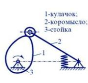
Служат для преобразования вращательного движения кулачка в поступательное движение толкателя или качательное движение коромысла.
