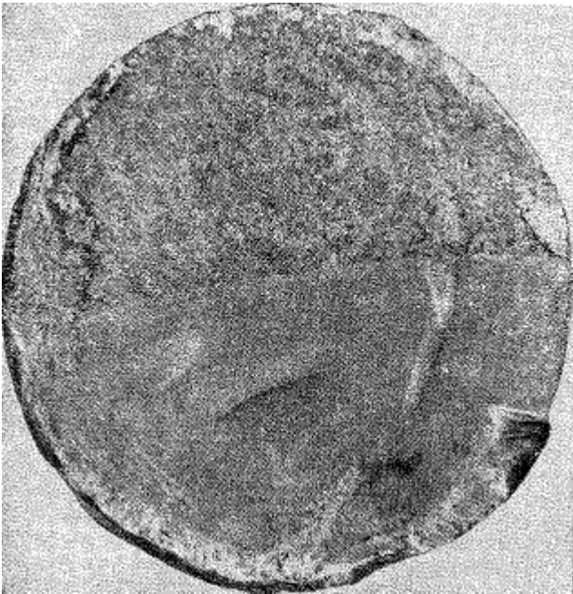
Рис.4. Характерные признаки усталостного разрушения
