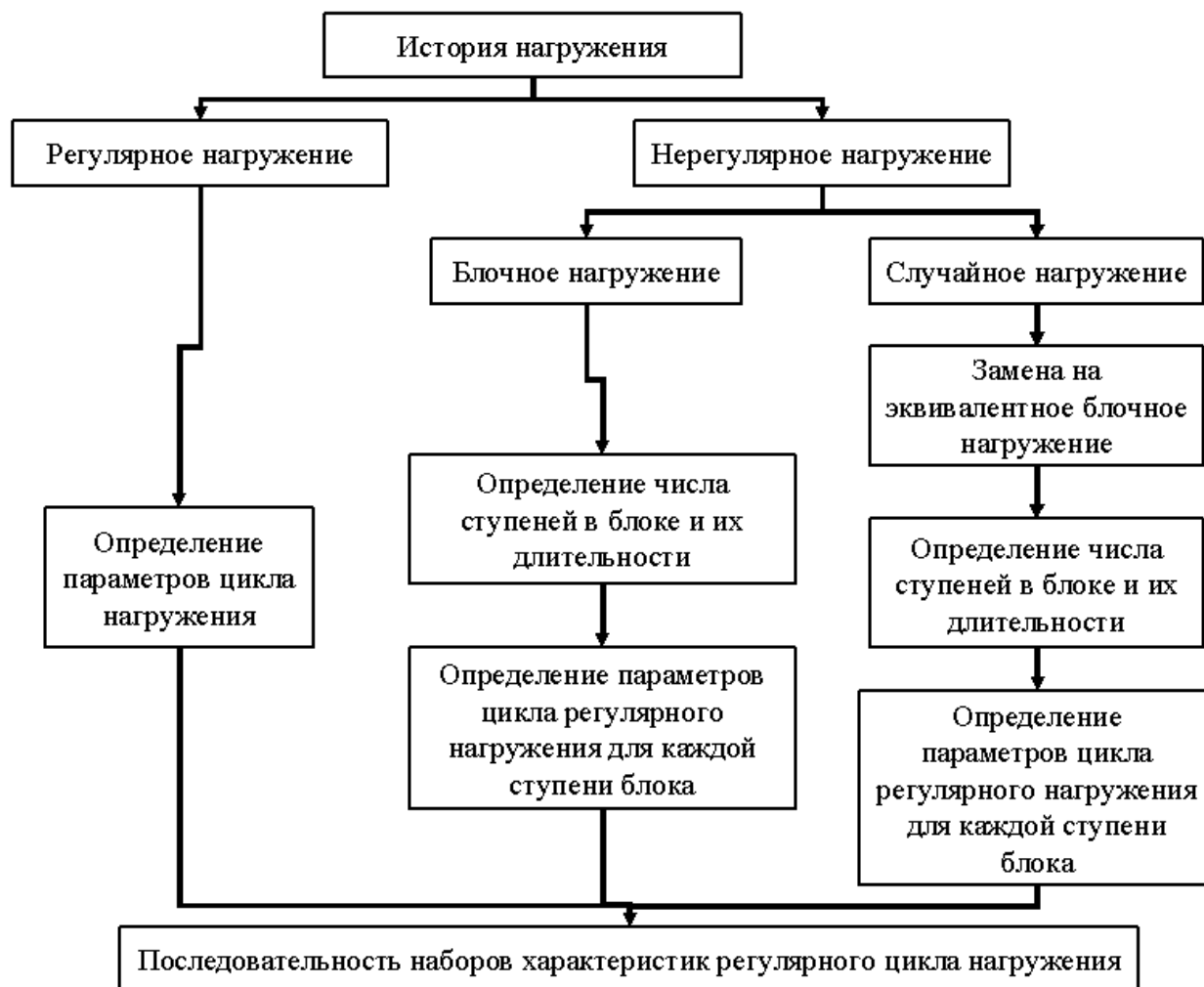
Рис. 3. Схема сведения истории нагружения в случае пропорционального нагружения
