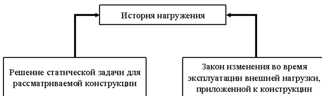
Рис. 2. Схема определения истории нагружения
