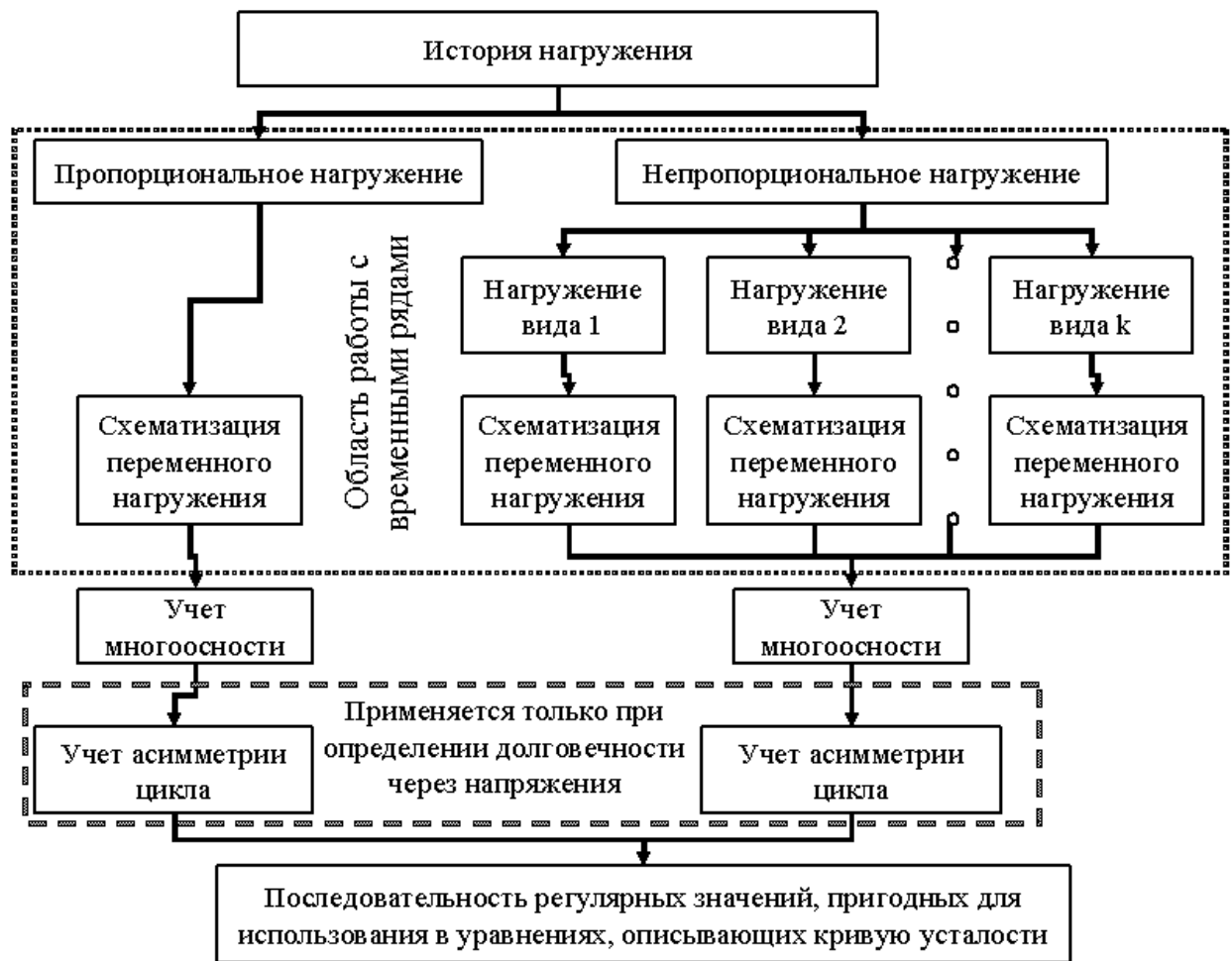
Рис. 5. Схема сведения истории нагружения в общем случае нагружения
