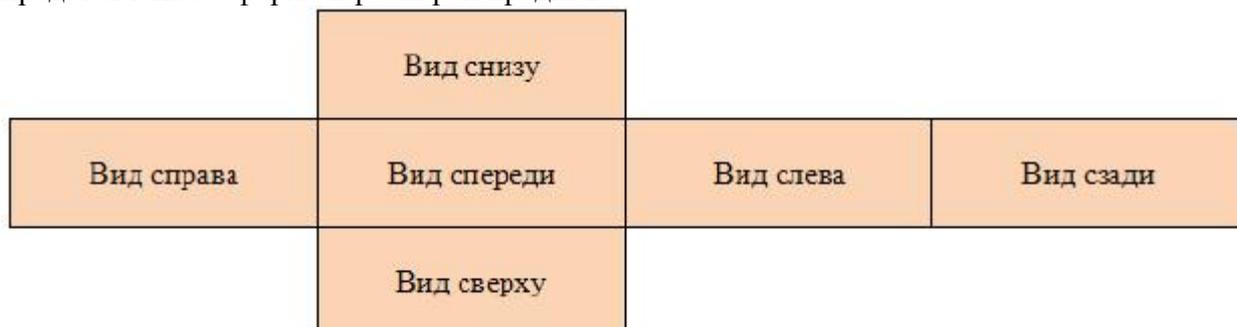
На рис.3 показано расположение видов чертежа "Вилка" по стандарту 2.305-68. Изображение на фронтальной плоскости мы принимаем за Главный вид. Положение каждого вида в системе координат чертежа определяется точкой привязки и углом поворота.
