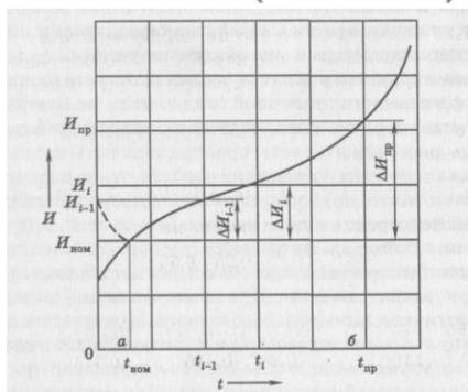
Рис. 1 - Схема определения остаточного ресурса
